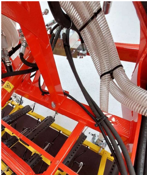
Abbildung 64: Schläuche zu den Prallblechen des Mittelrahmens 2
