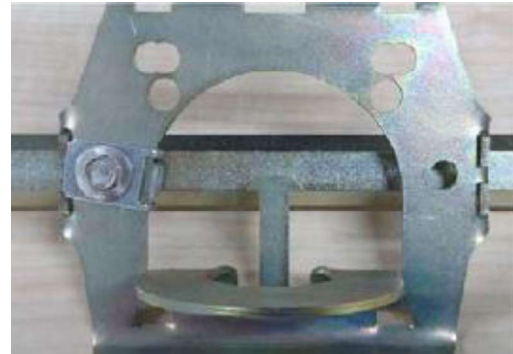
Abbildung 42: Auf der Sechskantstange aufgefädelt und befestigtes Prallblech
