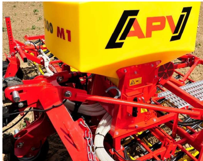
Abbildung 61: Schlauchverlegung vom PS ausgehend 1
