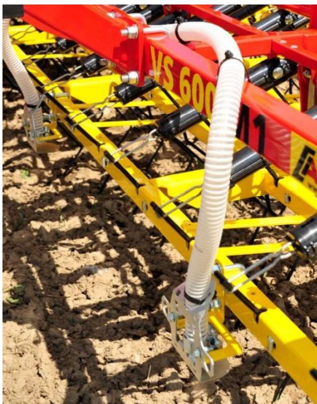
Abbildung 74: Schlauchverlegung entlang des Striegels 10
