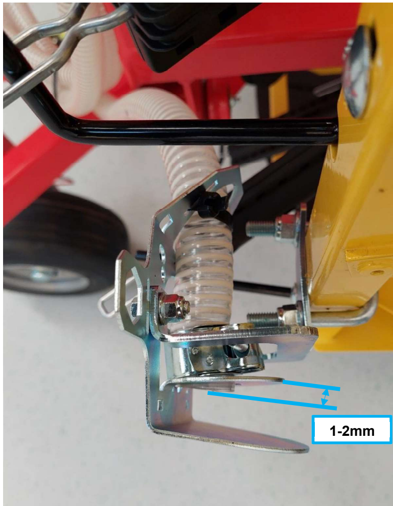
Abbildung 75: korrekte Verbindung von Säschauch und Prallblech
