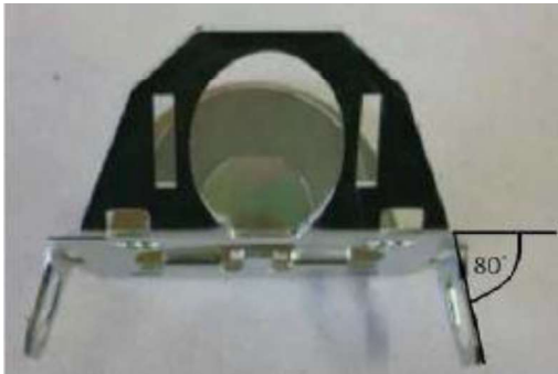
Abbildung 41: Biegung der seitlichen Prallblechlaschen
