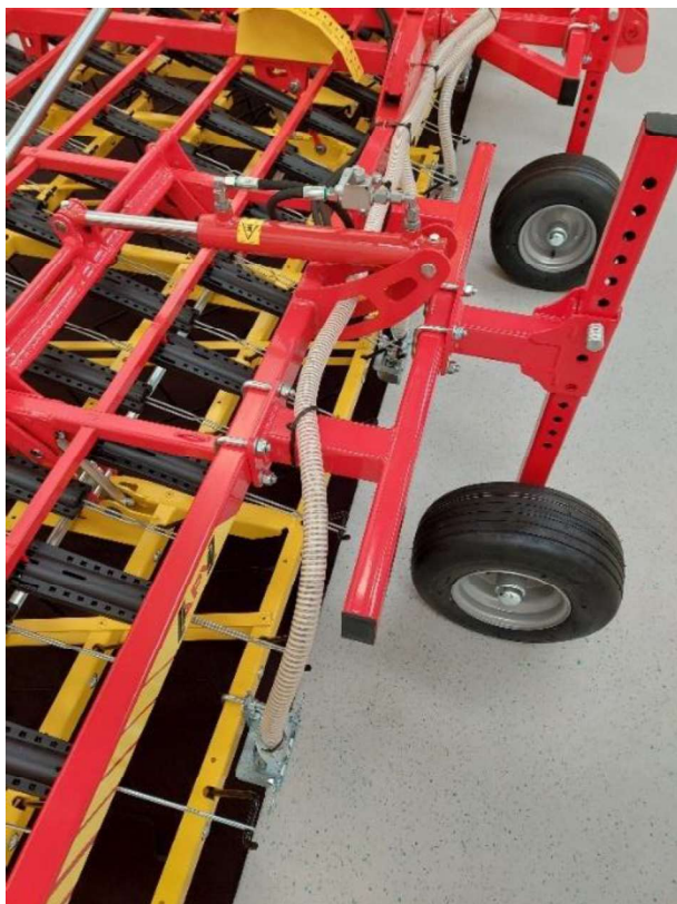
Abbildung 70: Schlauchverlegung entlang des Striegels 6
