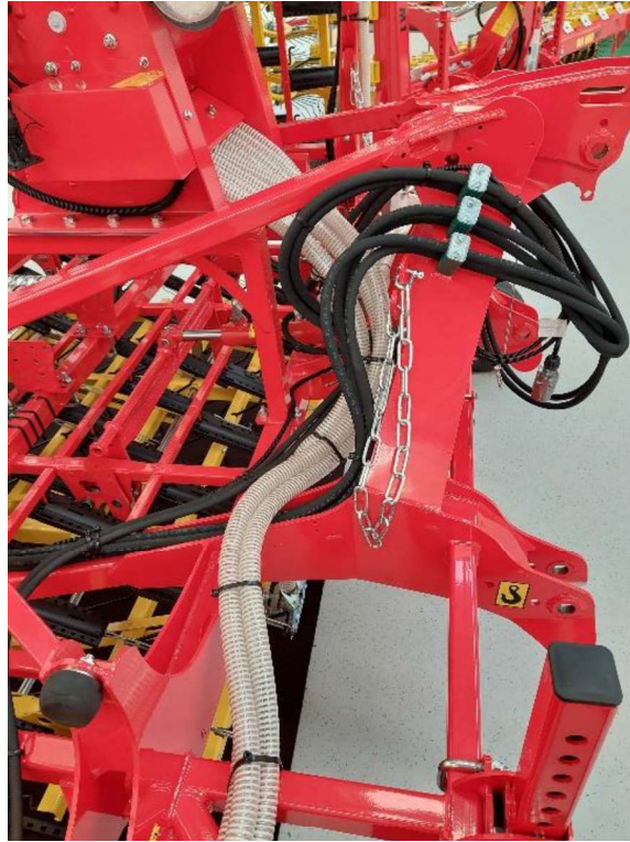
Abbildung 65: Schlauchverlegung entlang des Striegels 1
